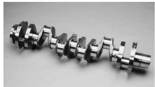
Fotografía B.1 Como estudiará en su curso de dinámica, el comportamiento rotacional del cigüeñal que se muestra depende de su momento de inercia de masa con respecto a su eje de rotación.
